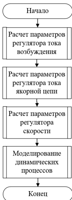
Рис. 6. Блок-схема алгоритма расчета системы управления для электропривода постоянного тока
