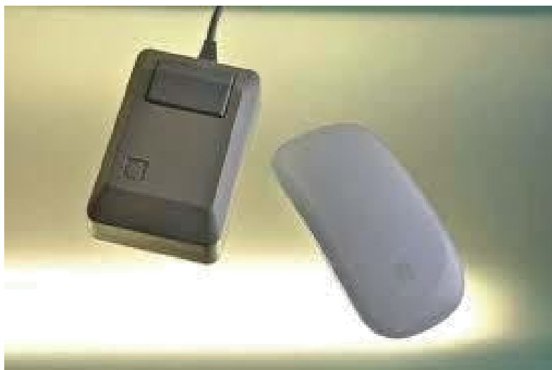
Рис. 2.23. Свертка системы манипулятор типа «мышь»: исчезли кнопки, колесико, шнур
