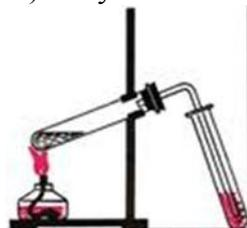
В сухую пробирку поместите 12 капель концентрированной серной кислоты, 4 капли этанола и бросьте кусочек неглазурованного фарфора, чтобы обеспечить равномерное кипение при нагревании. Вставьте в пробирку пробку с газоотводной трубкой и закрепите пробирку в лапке штатива.
